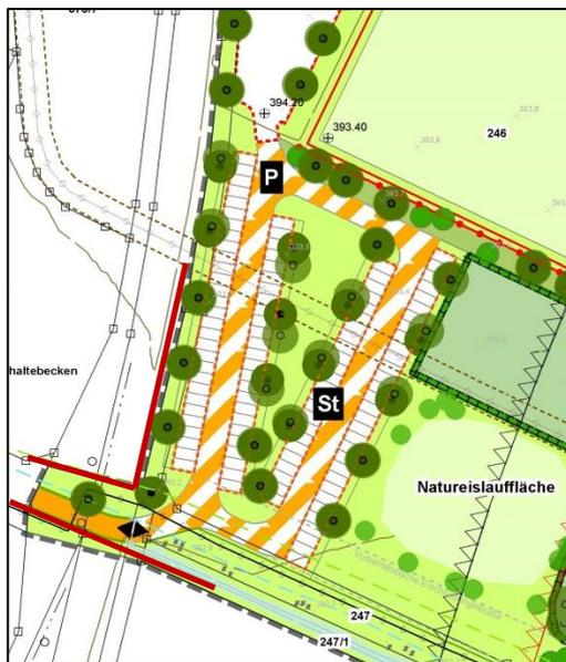
Abbildung 8: schematische Darstellung Verlauf der Amphibienzäune
